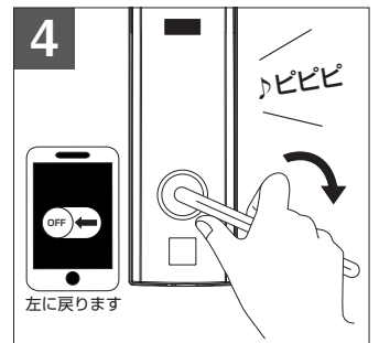
4 下矢印が表示されたらレバーハンドルを下げて、施錠します。
